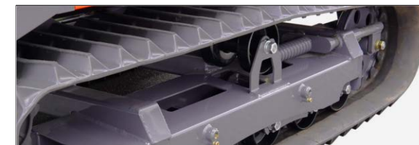
グリスアップ不要のトラックローラ・アイドラローラ・アッパーローラ
