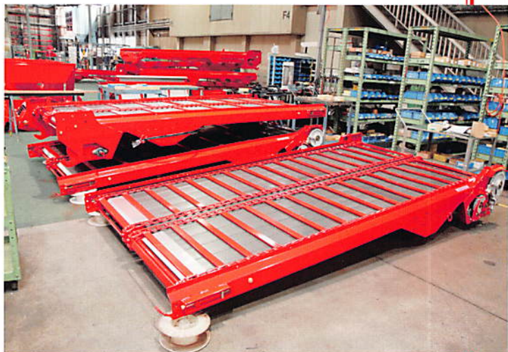
マニアスプレッタの荷台部分の部品。塗装を終え、組立作業を行っている
