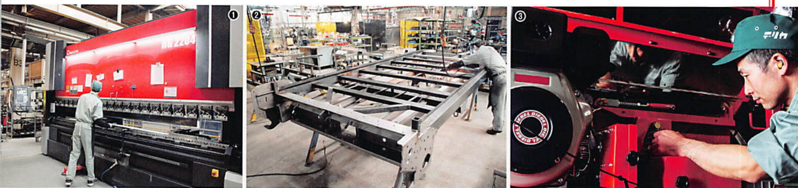
①曲げ工程の主マシンHG-2204。曲げ長さ4mまで対応する／②マニアスプレッタの荷台部分の溶接作業／③自走式マニアスプレッタの組立工程。小型機種はガソリンエンジン、10馬力以上の機種はディーゼルエンジンを搭載している
