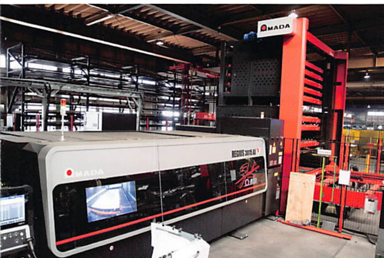
2021年3月に導入したファイバーレーザーマシンREGIUS-3015AJ (6kW、10段パレットチェンジャー付き)
