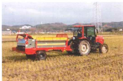
トラクタでけん引するタイプ。 トラクタの走行方向と連動してタイヤが動くステアリング車軸の機種もある
