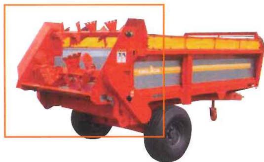
枠で囲んだ部分が散布羽がついた回転機構(ビータ)。写真は、横方向に設置した軸が回転し、荷台の堆肥を飛ばして農地に散布する横型ビータ
